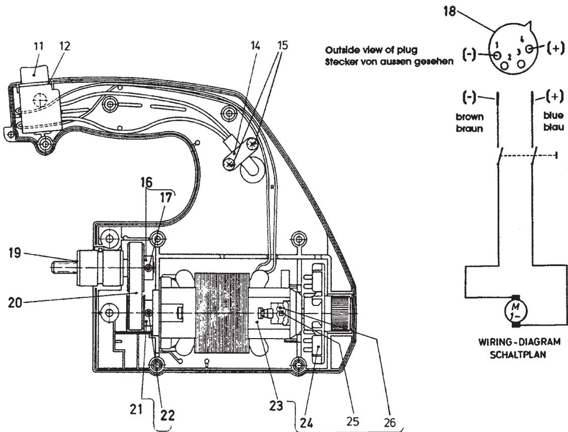
**MOTOR ASSEMBLY PART NO. 29929MB** (24V DC) STYLES 2200MB, MAB
