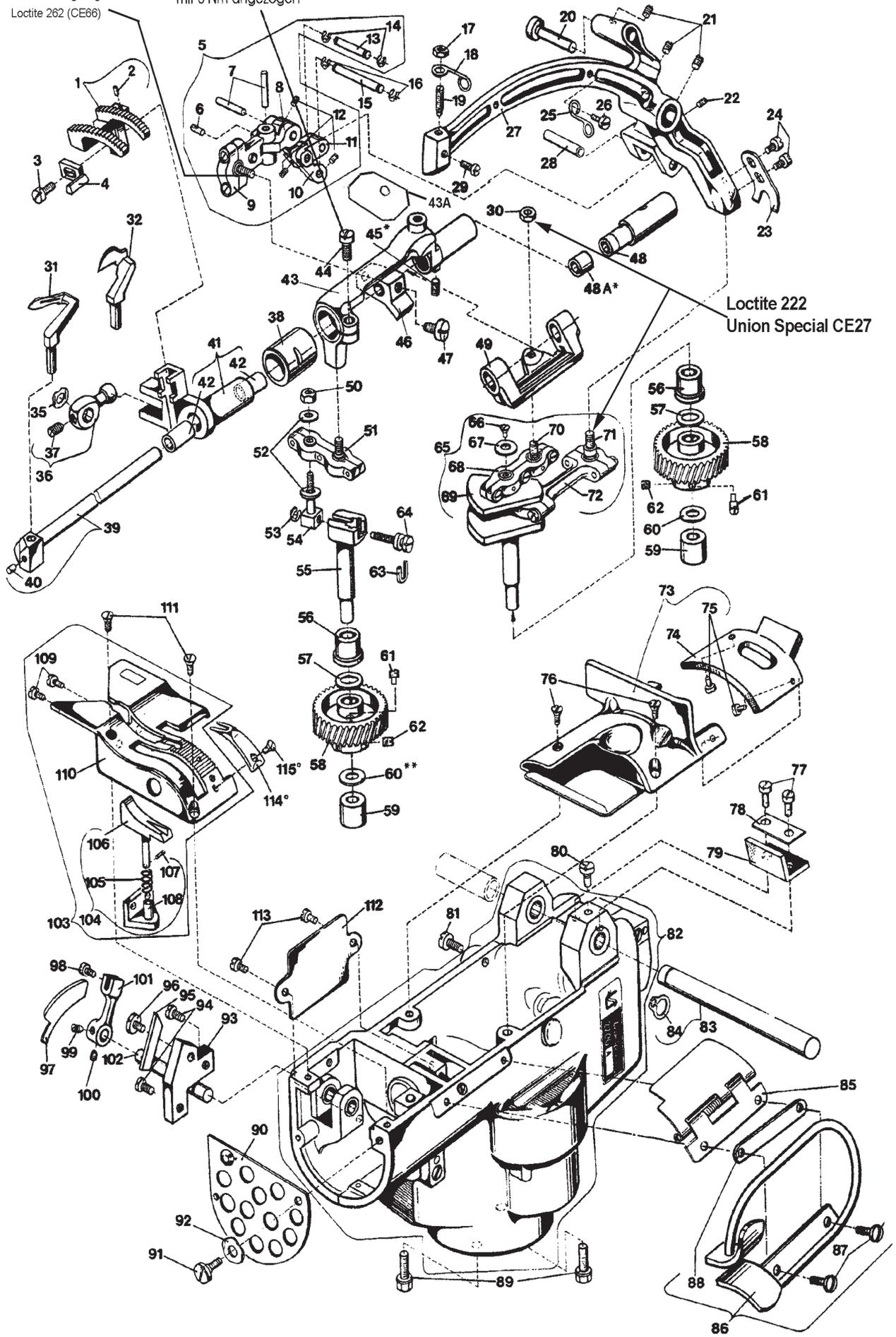
GEHÄUSE, KURBELWELLE, NADEL-, GREIFER-, TRANSPORT- UND KETTENABSCHNEIDERANTRIEB, TRANSPORTEUR, GREIFER, STICHPLATTE, ABDEK-
